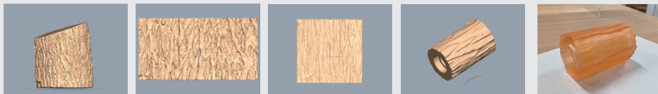
1) 木の幹をスキャン 2) テクスチャーを平面加工 3) テクスチャーの調整 押し型用に凹凸の反転 4) 湿式成形用ローラーへの加工 5) 3Dプリンターで出力
