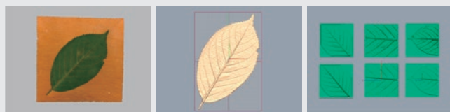
1) 桜の葉をスキャン 2) スキャンデータを平面上にマッピング 3) 金型サイズに加工
